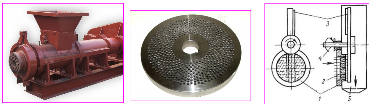
Рис 5: Оборудование для получения пеллет из высокозольного угольного шлама слева – шнек-экструдер, в центре – фильера, справа схема ножевого механизма:
